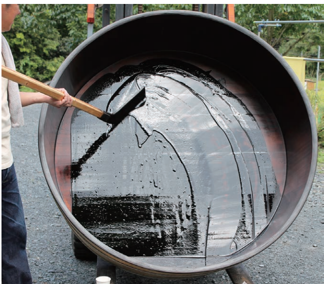
文中の桶より一回り小さい、黒漆専用1.4メートルのクロメ桶
