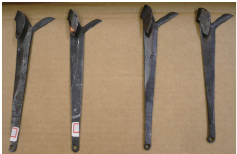
2012年12月 東京の刃物屋さん和二戸市の方に会入りお手伝いをして作られた漆掻き鎌
